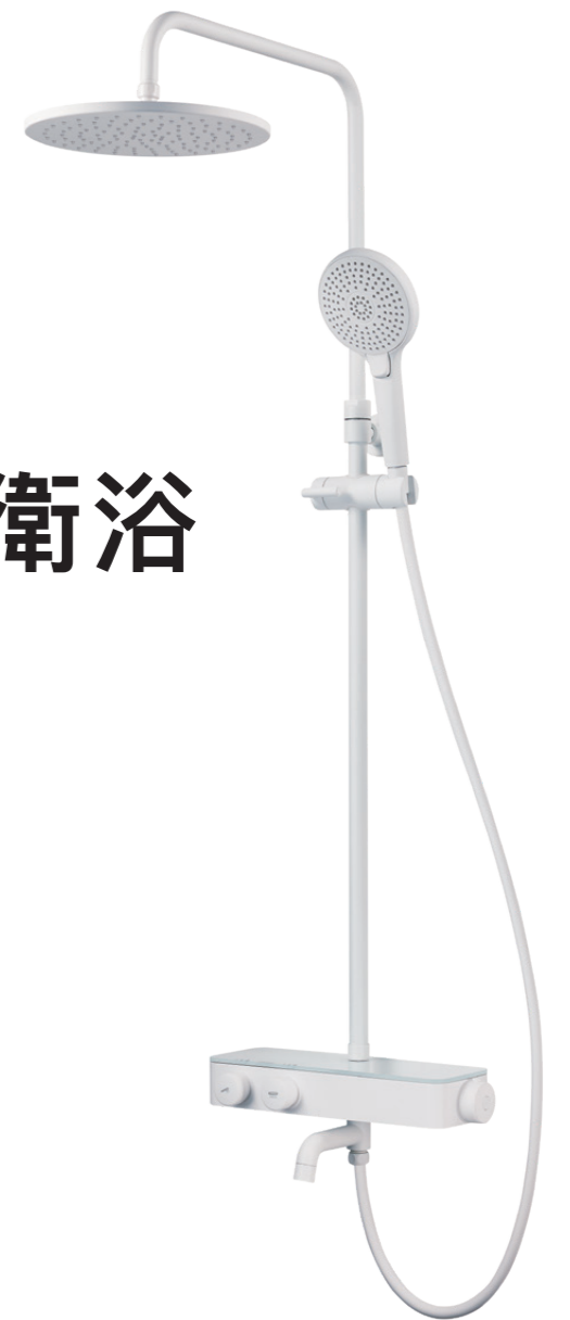
⑤ S788CW (詳情請參考 P94) (冷熱進水口中心離地 800mm 以上，間距 150±10mm)
